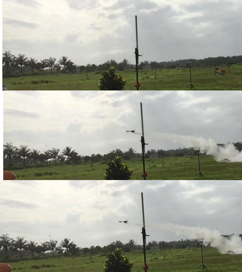
Gambar 3. 2 Cuplikan Hasil Uji Terbang Dummy RDX-200TJ
