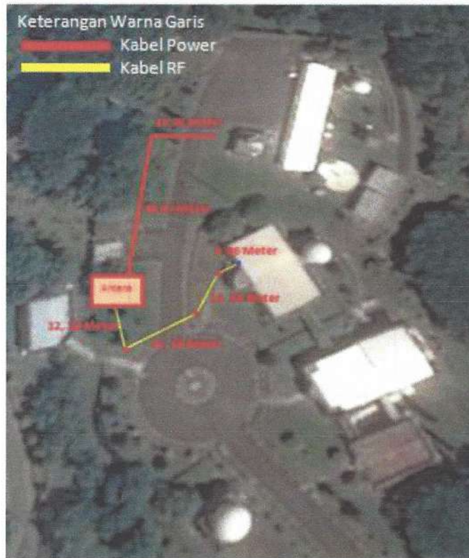
Gambar 8. Rencana alokasi antenna X-Band berdiameter untuk akuisisi data CSRST
