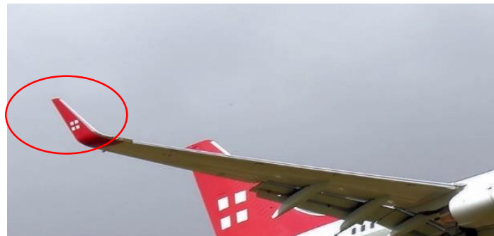
Gambar 1. Sayap Pesawat Boeing 737 dengan Penampang Blended Winglet
