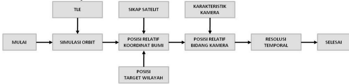
**Gambar 3. Diagram alir penentuan resolusi temporal suatu target wilayah**
