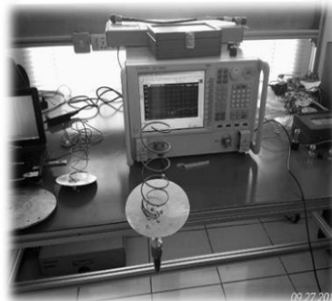
Gambar 4. Pengukuran antenna helix dengan PNA Network Analyzer
