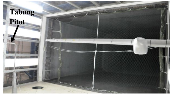
Gambar 1. Pemasangan model pada seksi uji
