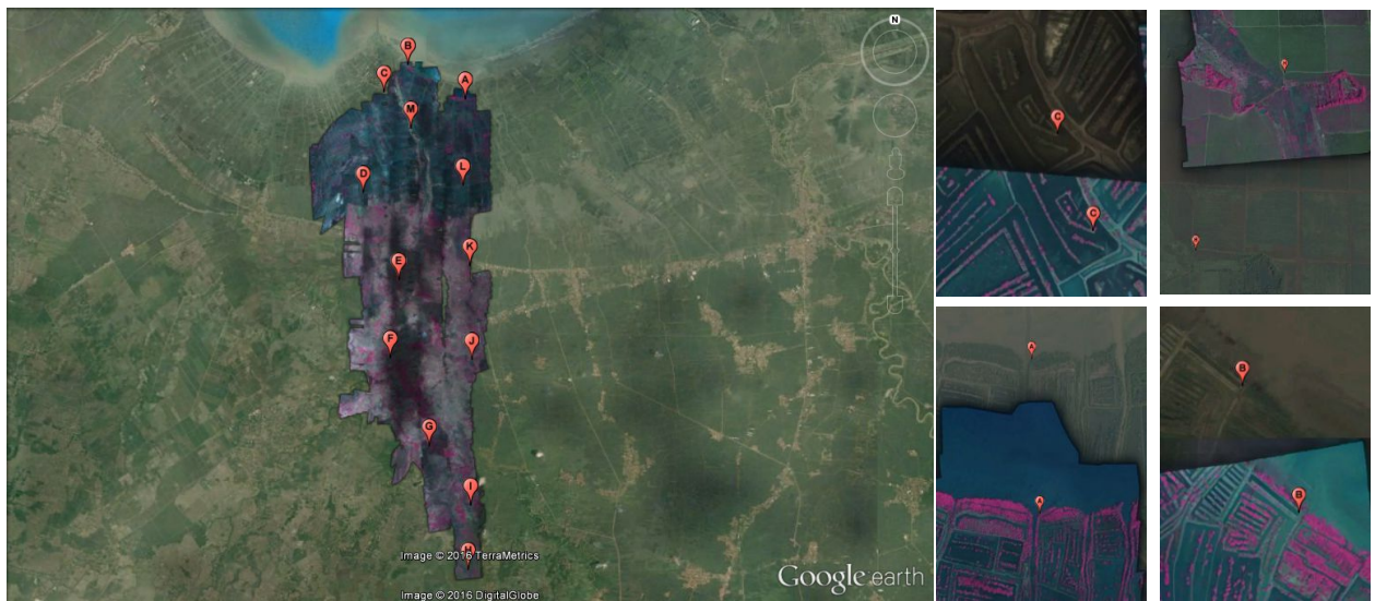
Gambar 10. Titik pengukuran pergeseran hasil mozaik LSA dengan sistem kontrol manual dan perbandingan lokasi pergeseran
