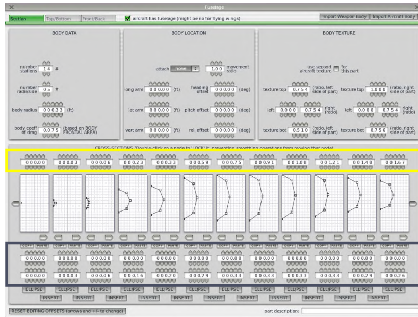
Gambar 3-3. Proses pemodelan fuselage di dalam plane maker
