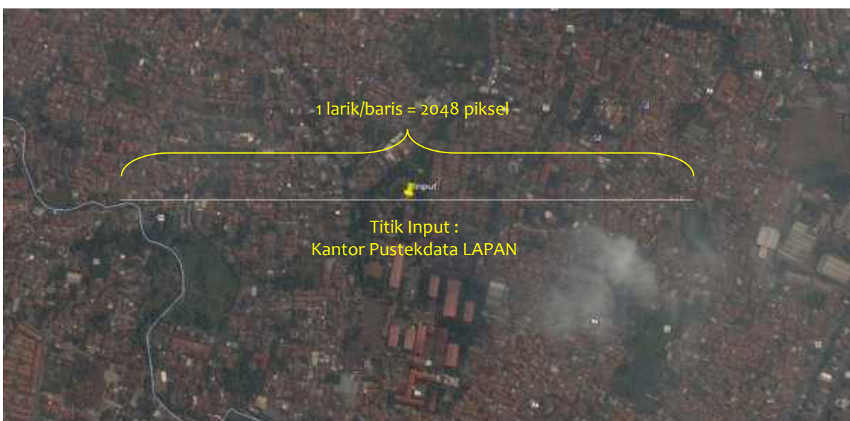
Gambar 12. Plotting koordinat longitude dan latitude pada google maps hasil simulasi direct georeferencing untuk 1 baris sensor linescan dengan jumlah piksel 2048 buah
