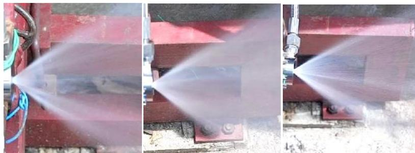
**Gambar 3-2** Pancaran oksidator dengan variabel sudut inlet  $90^\circ$ ,  $60^\circ$ ,  $45^\circ$  menghasilkan sudut bukaan pancaran masing-masing  $77^\circ$ ,  $72^\circ$ ,  $67^\circ$
