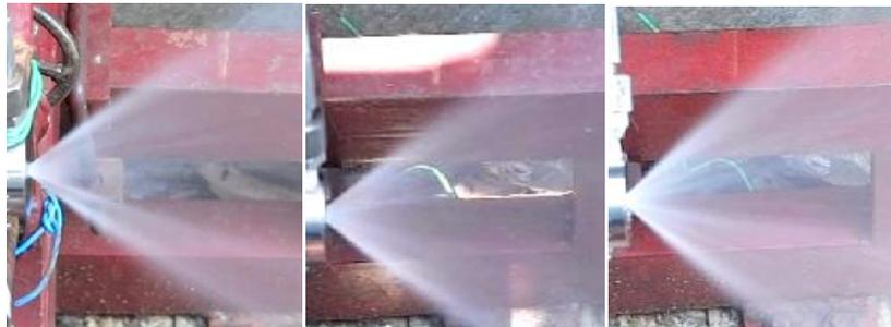
**Gambar 3-1** Pancaran oksidator dengan variabel sudut outlet  $90^\circ$ ,  $60^\circ$ ,  $45^\circ$  menghasilkan sudut bukaan pancaran masing-masing  $76^\circ$ ,  $78^\circ$ ,  $83^\circ$
