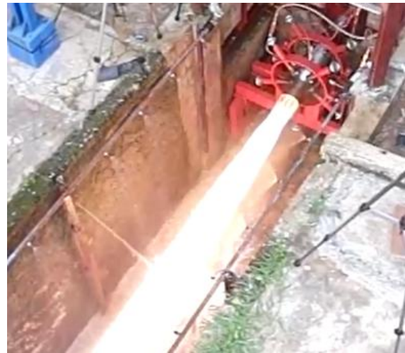
Gambar 5-10: Uji bakar enjin ECX1000H (kamera belakang atas)
