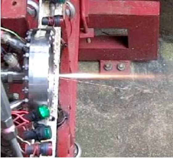
Gambar 5-9: Uji penyalaaan igniter
