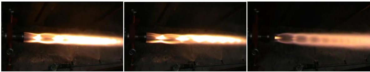
Gambar 5-11: Uji bakar mesin ECX1000H (kamera samping atas)
