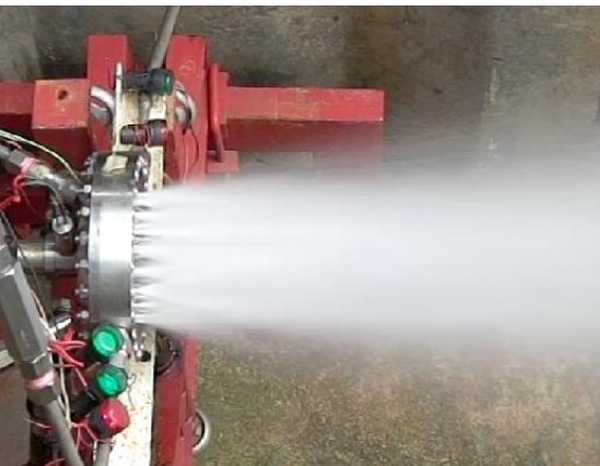
Gambar 5-4: Uji kabut injektor IJ-1T-KH-2-2; Kerosen dengan tekanan gas 40 bar (atas) dan Air dengan tekanan gas 39,3 bar (bawah)
