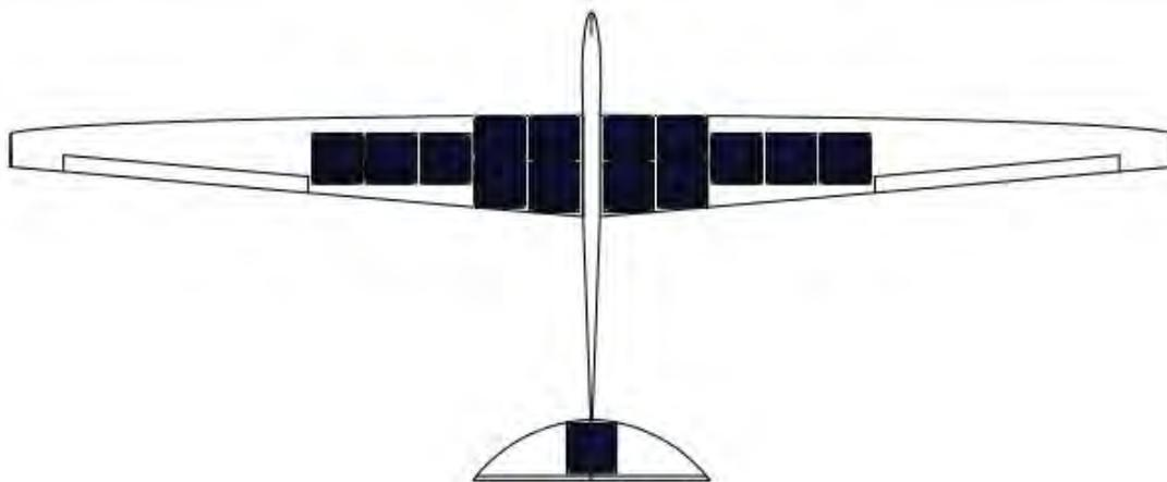
Gambar 4. Ilustrasi pemasangan sel surya Sunpower C60 pada Solar LSU
