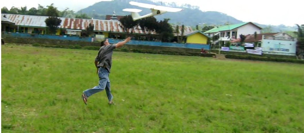
Gambar 5. Pesawat LSU-01 berhasil Take-off dengan dilempar sesuai dengan perencanaan . (Dokumentasi Bidang Avionik Pustekbang-LAPAN)
