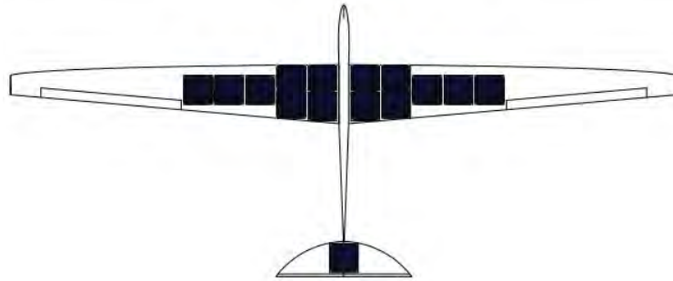
Gambar 1. Ilustrasi pemasangan sel surya pada Solar UAV[3]
