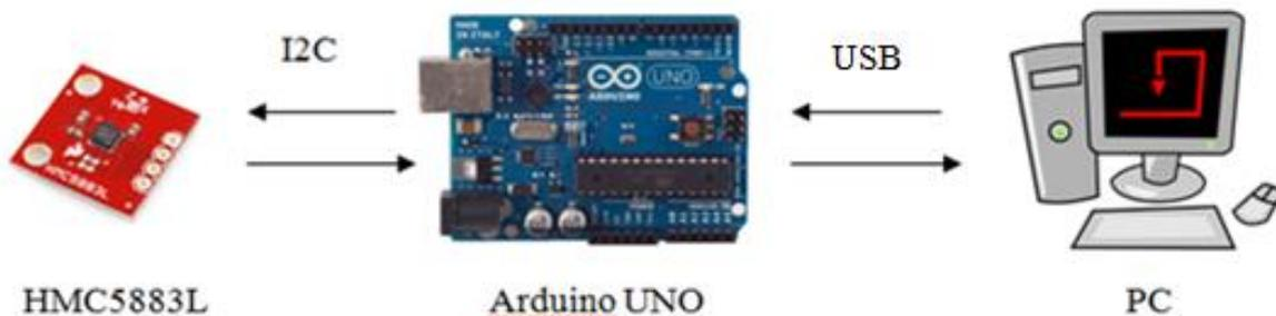
**Gambar 2-1** Diagram Blok Sistem Akuisisi Data *Magnetometer* HMC5883L
