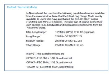
Fig. 1.Dafault Transmit Mode<sup>1)</sup>
