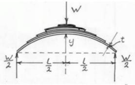
Fig. 3. Stress diagramsemi-elliptic leaf spring<sup>7)</sup>
