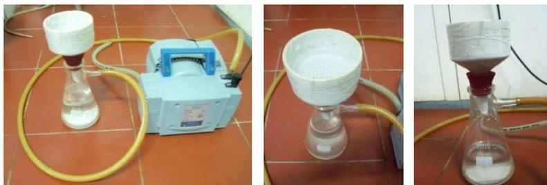
**Gambar 2.3.** Rangkaian peralatan penyaringan vacuum
