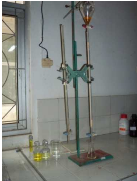
Gambar 4.3. Kolom penukar ion sederhana dengan buret
