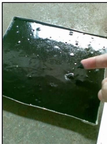
Gambar 3.3. Slurry Liner Setelah 1 Jam, Belum Curing
