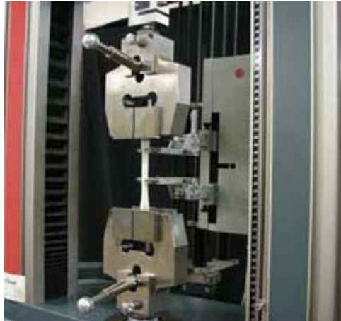
Gambar 6. Pengujian specimen komposit untuk menentukan kekuatan metrial komposit.
