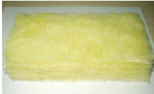
Gambar 3.1. Serat gelas (fiber glass) yang sudah tersusun sebagai filler komposit.
