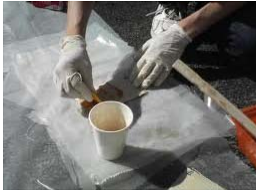
Gambar 3.3. Resin non-logam sedang dalam persiapan untuk digunakan sebagai matriks komposit.
