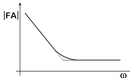
Gambar 4.2. Tanggapan frekuensi dari filter pada Gambar 4.1 (a).
