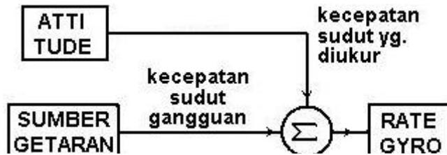
Gambar 3.3. Interferensi gangguan dengan kecepatan sudut pada gyro.
