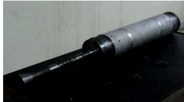
Gambar 4-2:Model uji motor 150-50 dengan blast tube nosel
