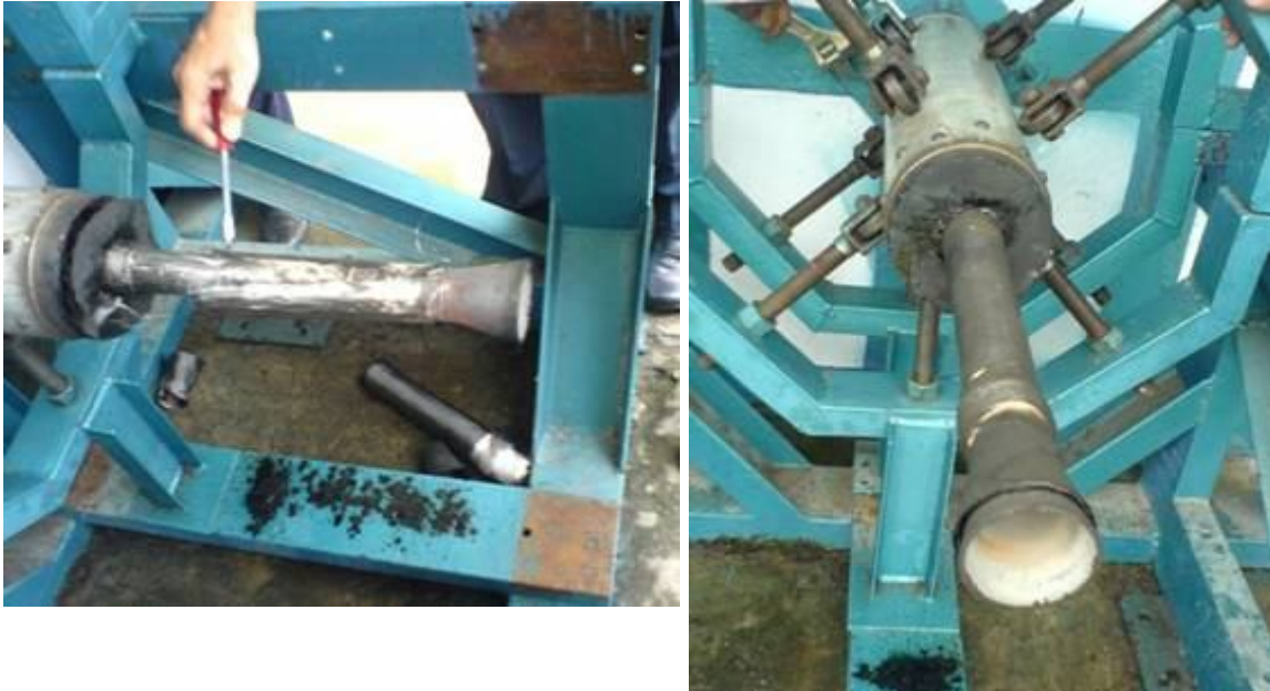
Gambar 4-4:Kondisi luar blast tube setelah uji statik
