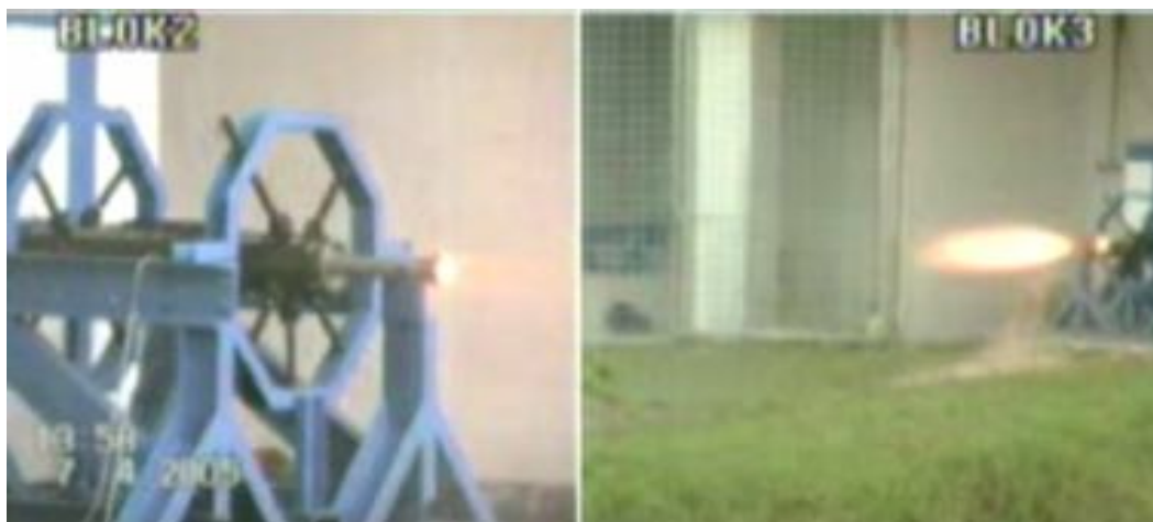
Gambar 4-3: Pengujian statik motor dengan blast tube nosel
