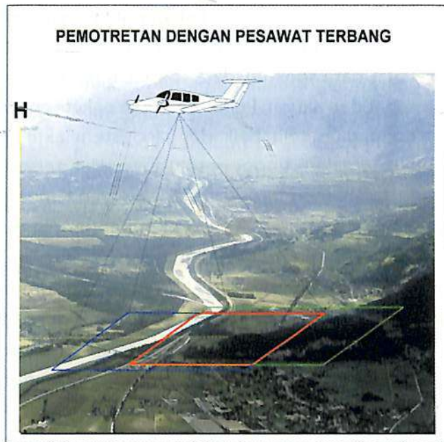
Gambar 2.2. Teknik Pemotretan Udara (Purwadhi dan Tjaturahono, 2008) Skala = f : H ; f = Panjang Fokus, H = Tinggi
