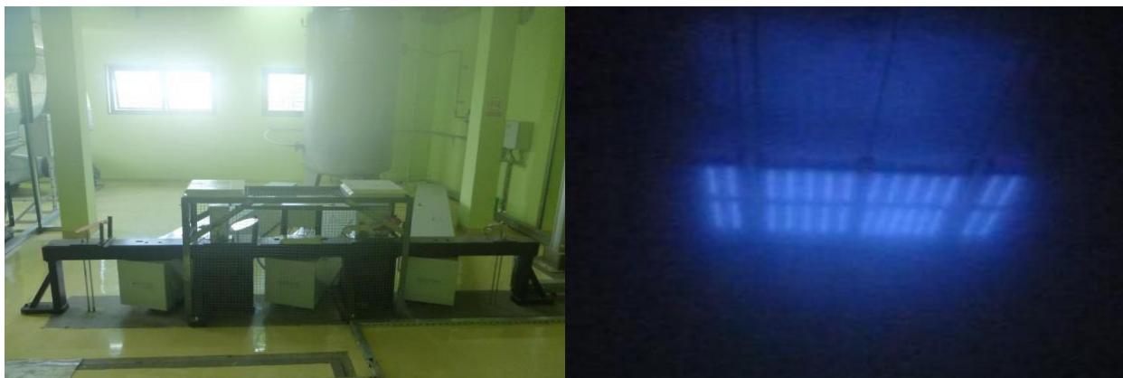
Gambar 3.16. Sistem pengangkat sumber dan Sumber Co-60 dengan aktivitas 300 kCi yang telah terpasang dalam kolam penyimpanan dan siap dimanfaatkan untuk mengiradiasi berbagai produk pangan
