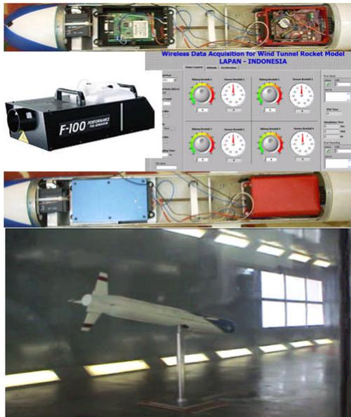
Gambar 4.1. Model Uav530 yang sedang diuji di terowongan subsonik
