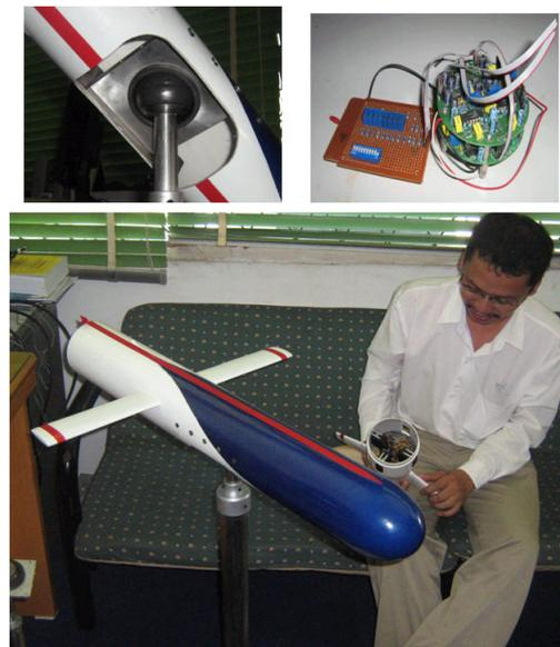
Gambar 3.3. model UAV530 untuk pengujian struktur dengan strain gage pada sayap dan sirip
