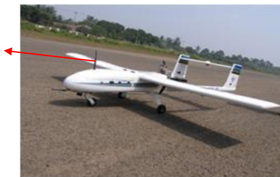
Gambar 1. Wujud LSU-02 dengan antenna radio komunikasi telemetri dan command [14]
